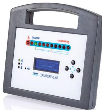
Mobiler industrieller Lecksucher für kleine bis mittlere Produktionsgrößen. Anwendbar für verschiedene Kältemittel und H<sub>2</sub> Spurengas mit nur einer Handsonde. Selbst kleinste Leckagen können schnell und präzise lokalisiert werden. Das Gerät verfügt über 2 einstellbare Alarmstufen.
