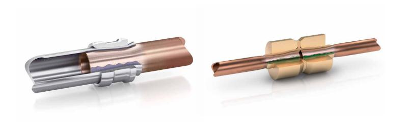
IL LOKPREP, sigillante anaerobico, viene distribuito tra la tubazione interna ed esterna prima che la connessione venga realizzata. In assenza di aria, il LOKPREP polimerizza rimanendo elastico e garantisce la tenuta nei confronti delle microperdite causate dalla non regolarità delle superfici delle tubazioni.
